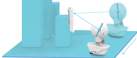
一体机发生移位时，会自动调整方向及角度，完全无需人工干预
